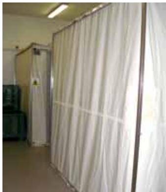
Kontrolētās atmosfēras telts sistēma augļu uzglabāšanai, Laimburga, Itālija Projektsf `GoodFruit` 2008
